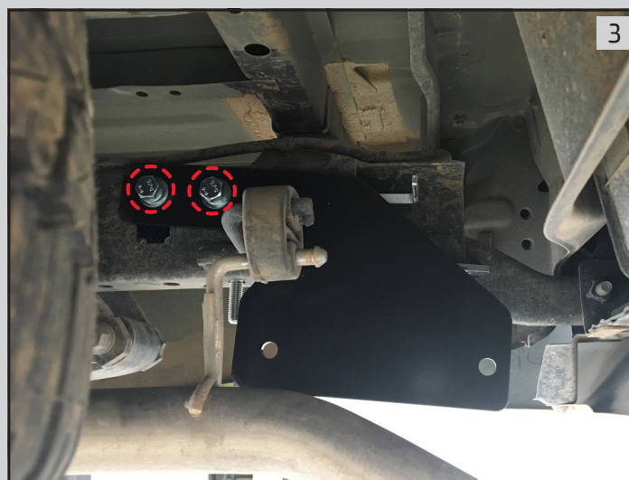
חבר את המחבר הימני (C) אל השסי באמצעות 2 ברגים (J), שייבה קפיצית (N) ושייבה (M) אל הברגות הפחית על פי המומנטים המופיעים בטבלה בעמוד 2
