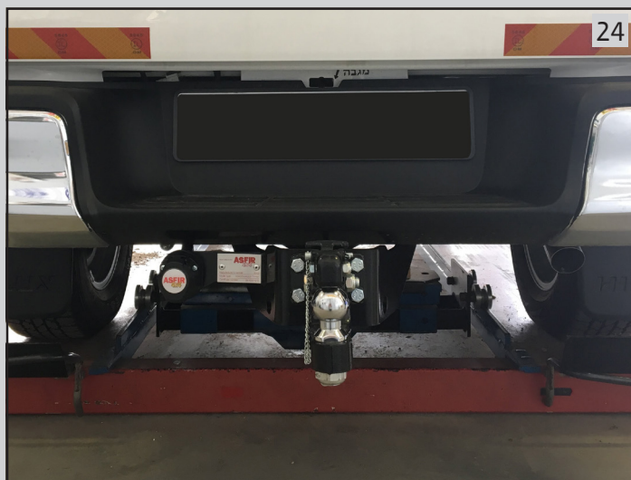
לאחר השלמת הרכבת התקן הגרירה וחיבורו לחשמל הרכב יש לחבר את הנגרר ולוודא כי אורות הנגרר עובדים כנדרש
