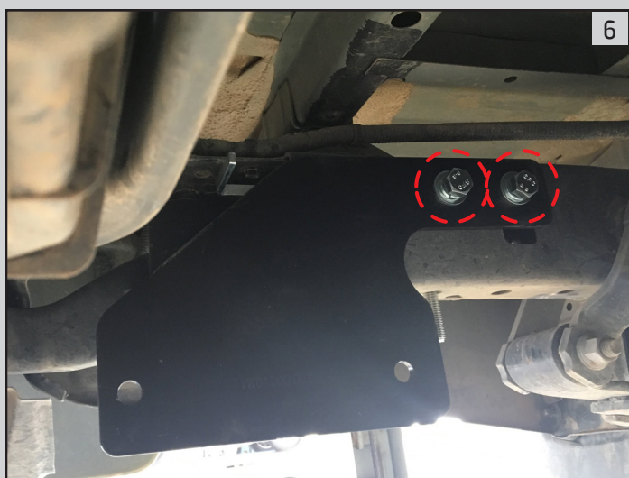
חבר את המחבר השמאלי (C) אל השסי באמצעות 2 ברגים (J), שייבה קפיצית (N) ושייבה (M) אל הברגות הפחית על פי המומנטים המופיעים בטבלה בעמוד 2
