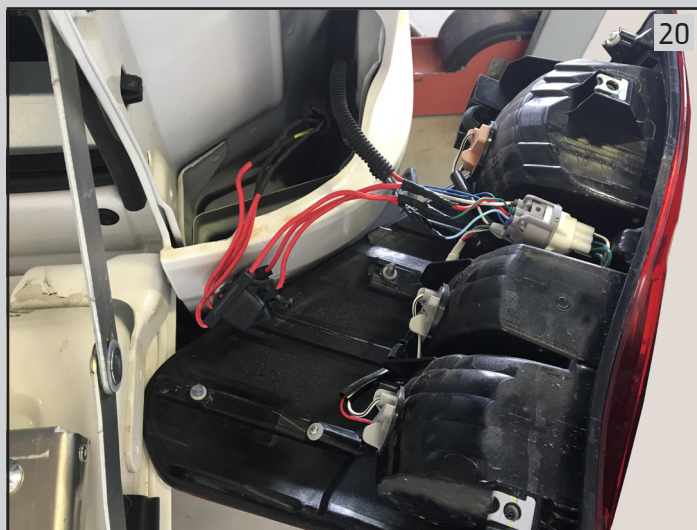
בשלב זה חבר את הצמה המגיעה משקע התקן הגרירה לצמות של שני פנסי הרכב ע"פ שרטוט החשמל המצורף (עמוד 7)
